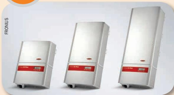
L'inverter è un convertitore statico di corrente da continua (prodotta dai moduli) ad alternata a 230 V (in uso in Italia), per impiegarla nell'alimentazione delle normali utenze domestiche, o per immetterla nella rete elettrica. Gli inverter "grid connected" servono ai sistemi che riversano la corrente in rete e devono sintonizzarsi con frequenza e tensione. Gli inverter "stand alone" sono collegati agli accumulatori (batterie) e necessitano di un regolatore di carica.
