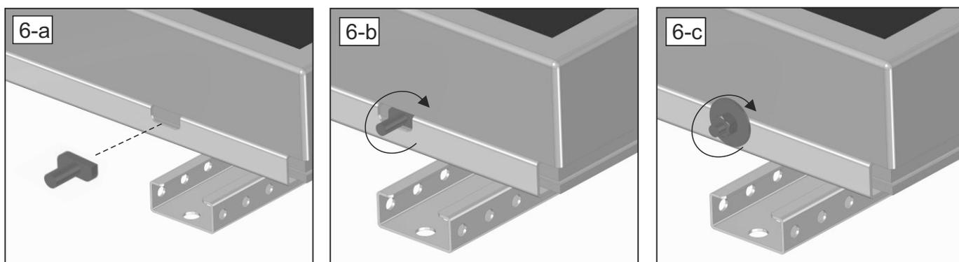
7- Appoggiare il pannello tra i due profili precedentemente montati sul telaio e fissarlo sul profilo ad «L» utilizzando le viti testa a martello seguendo le istruzioni di fase 8.
