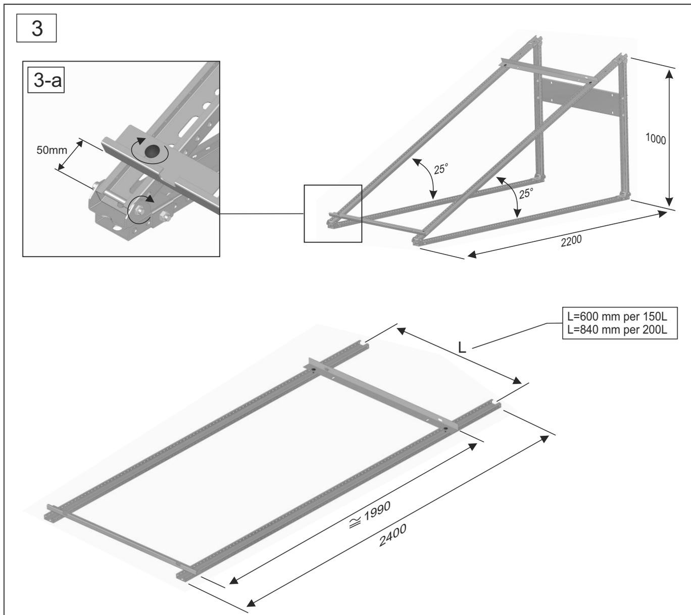
4- Fissare le selle per il bollitore sui profili come rispettando il posizionamento delle stesse (vedi sequenza *tetto inclinato*). In contemporanea fissare anche i giunti.
