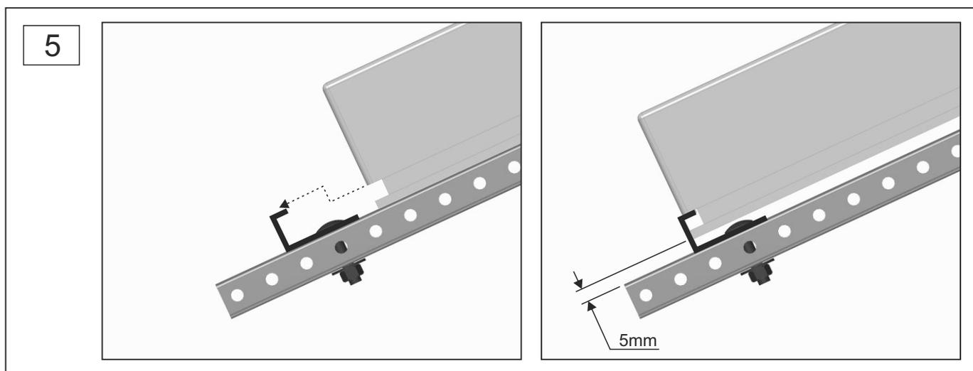
6- Inserire le viti TESTA A MARTELLO M8x20 nelle asolature e internamente alla cornice del pannello (FIG. 6-a).
