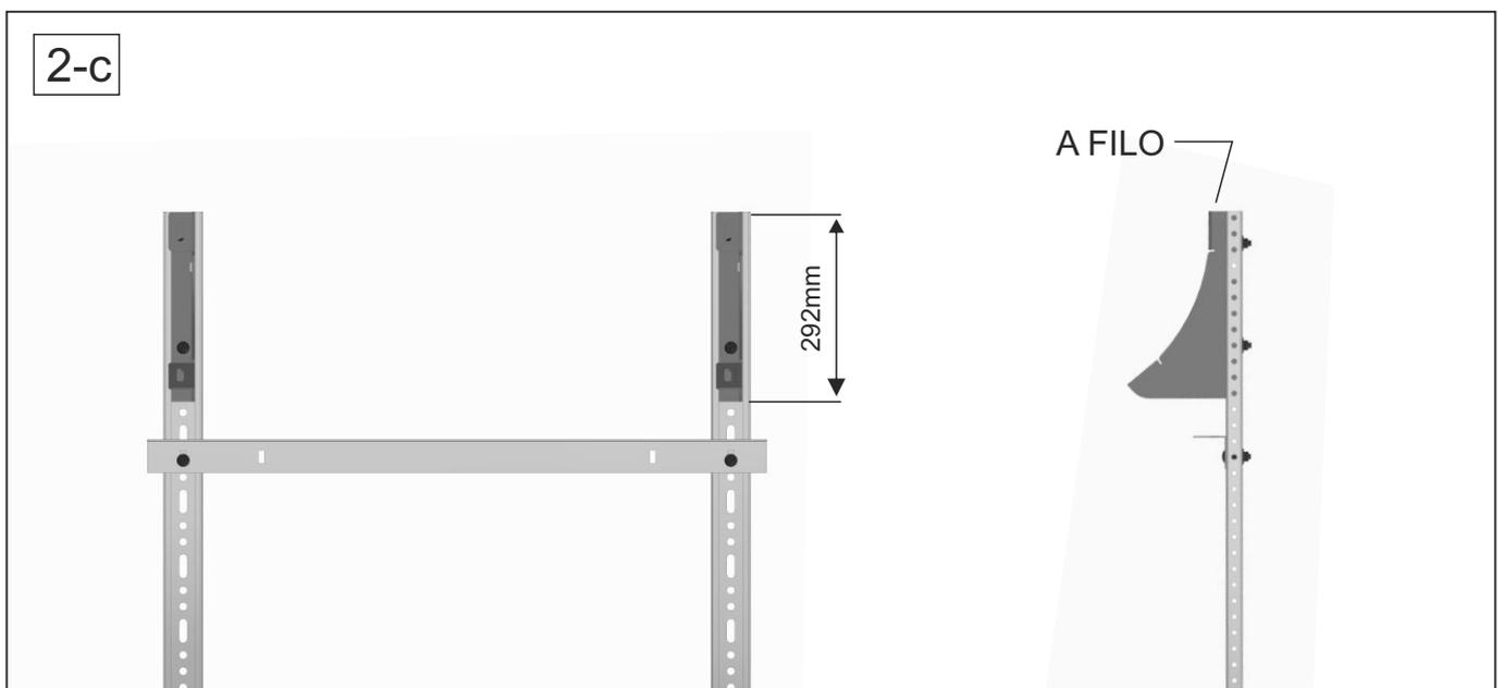
3- Fissare il telaio appena premontato sul tetto utilizzando i sistemi di fissaggio SUNXL
