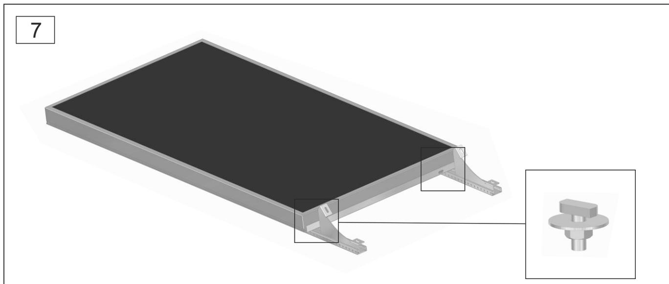
8- Inserire le viti TESTA A MARTELLO M8x20 nelle asolature e internamente alla cornice del pannello (FIG. 8-a).
