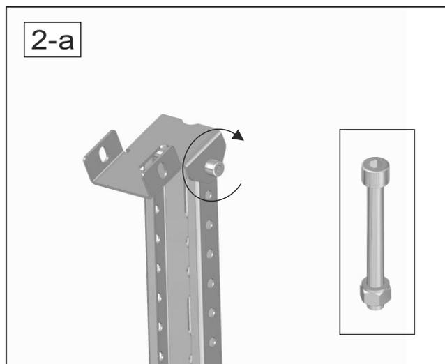
3- Una volta preparato la struttura a triangoli, fissare il telaio precedentemente preparato (vedi sequenze *tetto inclinato*) utilizzando le viti TCEI M8x75
