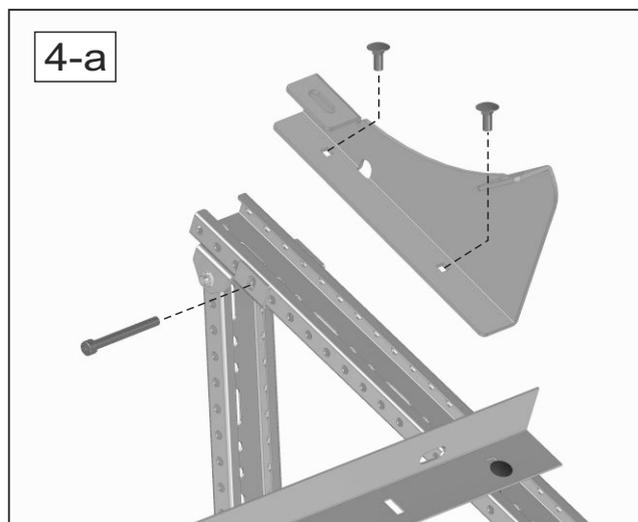
5- Fissare le selle per il bollitore sui profili come rispettando il posizionamento delle stesse (vedi sequenza tetto inclinato FIG.1). In contemporanea fissare anche i giunti.
