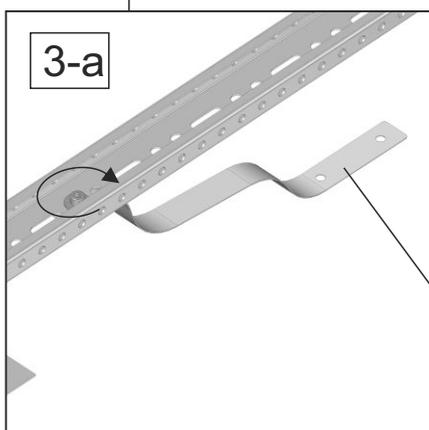
I profili SUNXL (n° 4 pezzi) sagomabili in acciaio inox devono essere ancorati saldamente alla copertura con appositi tasselli non inclusi nel kit
